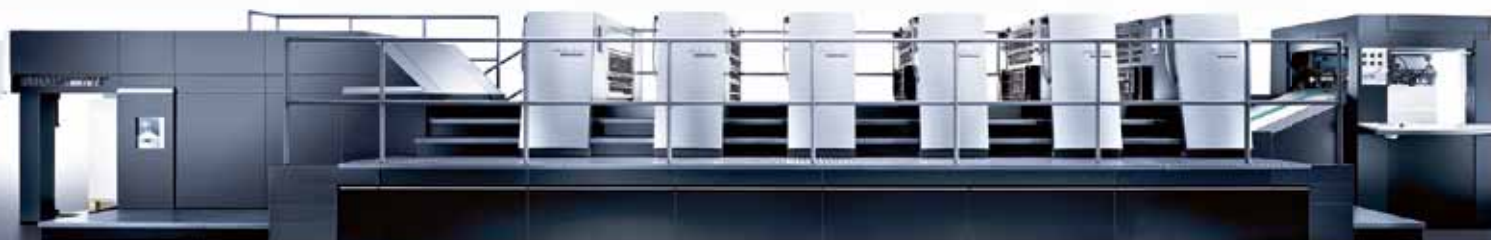
Druckmaschine der Fa. Heidelberg Speedmaster XL-105-5+L · Bogenformat bis 75 cm x 105 cm
